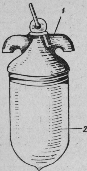
Рис. 36. Фарфоровый полугерметический светильник: 1 — фарфор; 2 — стекло.
